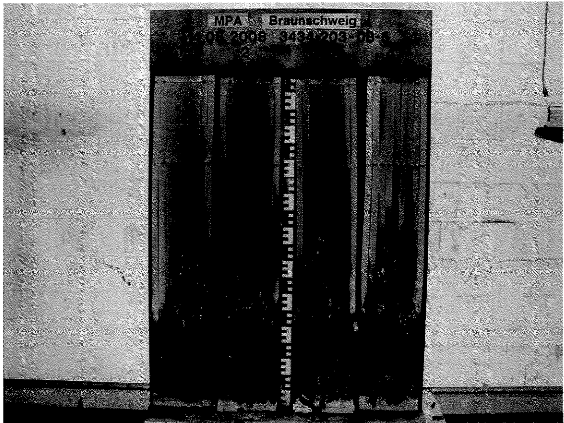
Aussehen des Prüfkörpers 1 (Lamelle) nach der Brandschachtprüfung
